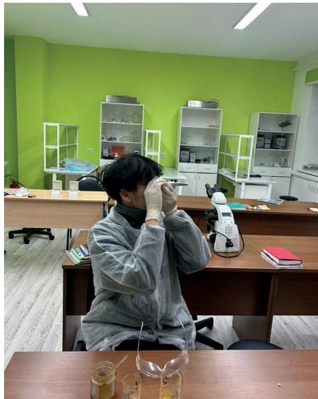
Рис. 3. Определение массовой доли воды портативным рефрактометром
