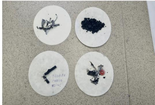
**Рис. 3.** На фотографии: черный порошок – оксид марганца (2) + угольный порошок, металлическая стружка (корпус гальванического элемента), цинковый стержень
