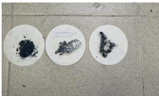
Рис. 2. На фотографии черный порошок – оксид марганца (2) + угольный порошок, голубой порошок – цинковый порошок, металлическая стружка (корпус гальванического элемента), цинковый стержень отсутствует
