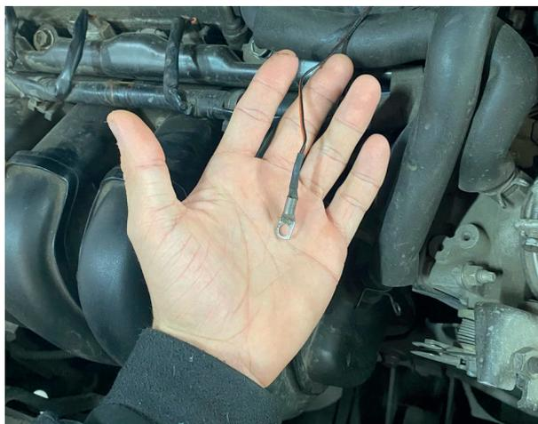
Рис. 7. Датчик температуры на сигнализации
