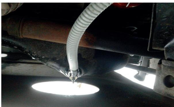
Рис. 4. Установленная пробка в картере
