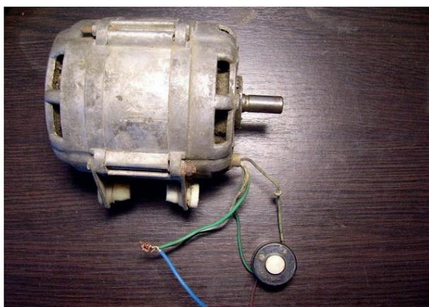
Рис. 4. Подключение контактора без фиксации к выводу ПО
