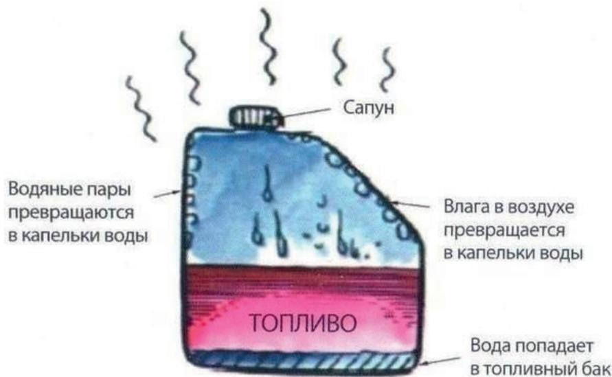
Рис. 1. Процесс накопления влаги в бензобаке
