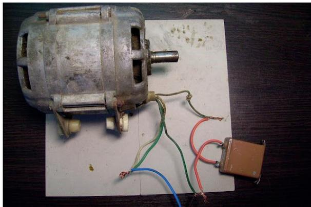
Рис. 3. Предварительное подключение мотора для проверки его работоспособности
