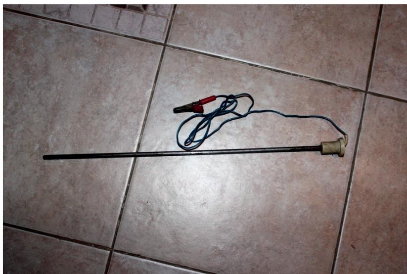
Рис. 8. Нагреватель, который используется в качестве щупа
